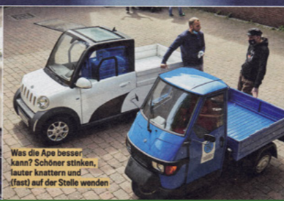
Der E-Motor mit 7,5 kW Leistung treibt die Hinterräder an, stößt beladen schnell an seine Grenzen
